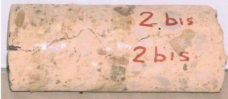
■ Figura 9. Il taglio a profondità insufficiente e la presenza delle fibre in acciaio non hanno consentito la frattura della lastra.
